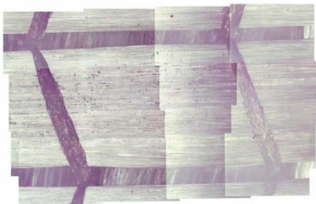
Fig.1. The 90° layer of ELT850.
